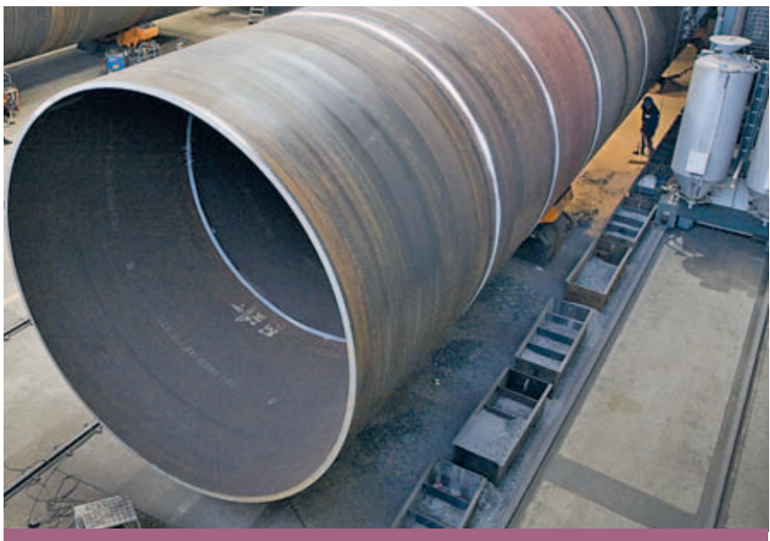
Sif Groep in Roermond maakt funderingspalen voor windmolens, 70 meter lang, 525 ton zwaar.
